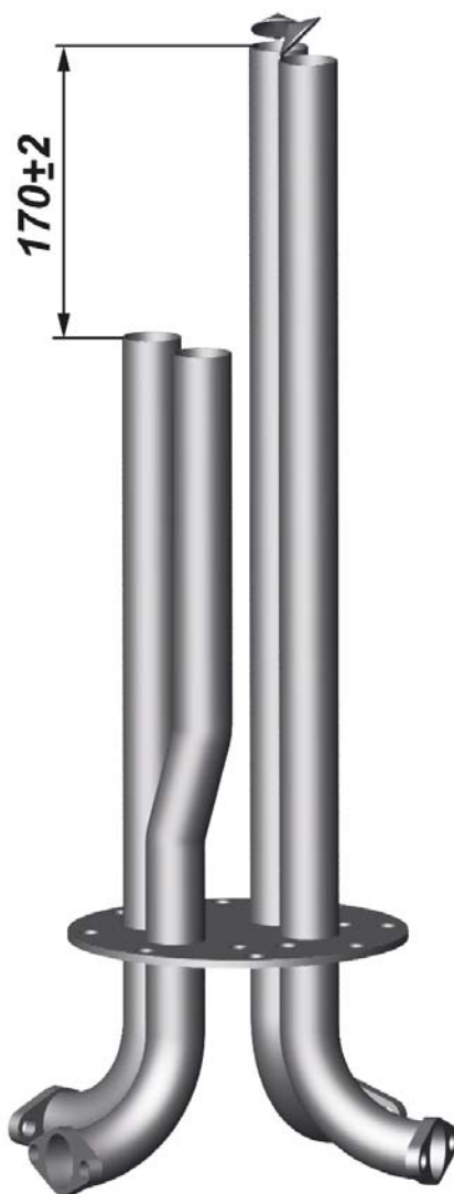
Рис.6 - Отрезка водоналивных труб распределительной батареи с межосевым расстоянием 60 мм.
